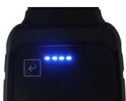
Dans la plupart des cas, la mise à jour du système se fait automatiquement. Les LED bleues et un signal sonore informent que **WM Remote** est en train de faire une mise à jour (lors de la mise à jour, l'outil doit disposer d'une connexion internet et être branché sur la prise de diagnostic du véhicule pour disposer d'une alimentation électrique).
