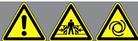
Bei Arbeiten am Fahrzeug besteht Verletzungsgefahr durch rotierende Teile oder durch das Wegrollen des Fahrzeugs.
